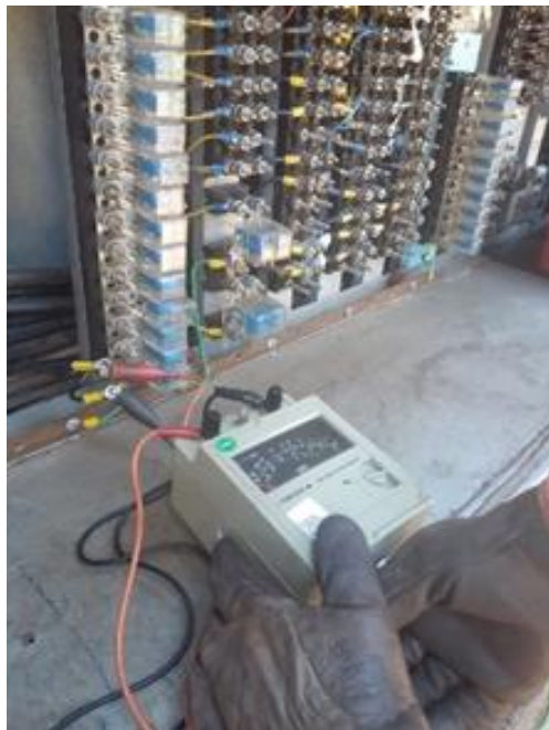
Figura 2. Emprego do megômetro para diagnóstico da qualidade dos cabos metálicos a cada cinco anos.
